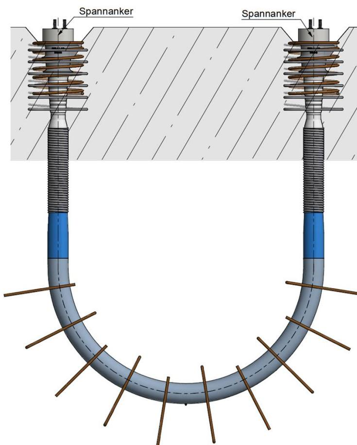
Vorspannsystem BBV Typ i - Litzen-spannverfahren zum internen Vorspannen im nachträglichen Verbund und Anwendungsbestimmungen
