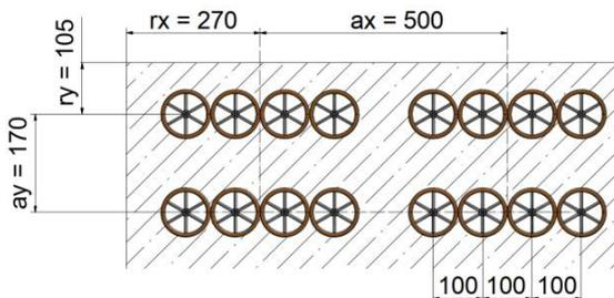
Es dürfen auch 2x14 Ø8 Steckbügel verwendet werden, die mit  $l_s = 420 \text{ mm}$  zu übergreifen sind.
