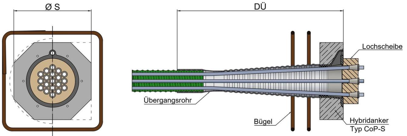
Spanngliedtyp BBV L3 i– L31 i, Spannanker und Festanker mit Hybridankerplatte (Seitenlänge S) und Lochscheibe.
