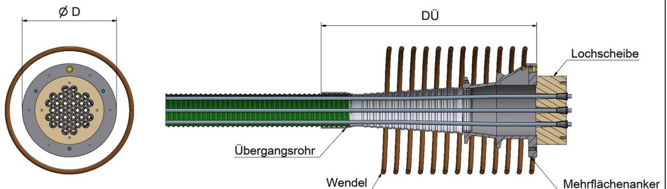
Spanngliedtyp BBV L12 i – L31 i, Spannanker und Festanker mit Mehrflächenanker  $\varnothing D$  und Lochscheibe
