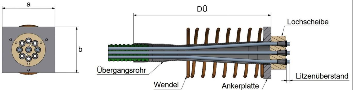
Spanngliedtyp BBV L3 i – L9 i, Spannanker und Festanker mit rechteckiger Ankerplatte  $a \times b$  und Lochscheibe
