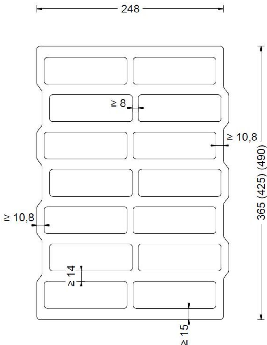
Alternative Stirflächenausbildung unter Einbehaltung der Mindeststegdicken möglich
