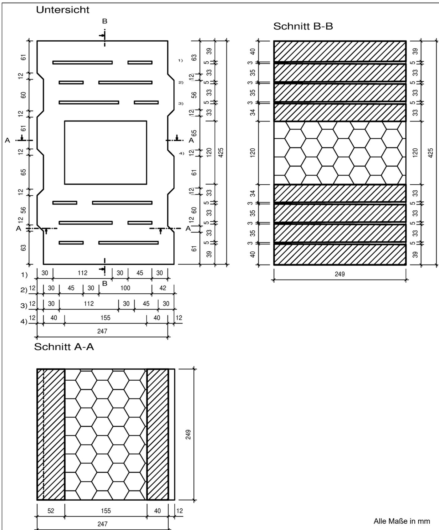
Mauerwerk aus Planhohlblöcken mit integrierter Wärmedämmung - bezeichnet als Delfing-Thermstein SK - im Dünnbettverfahren
