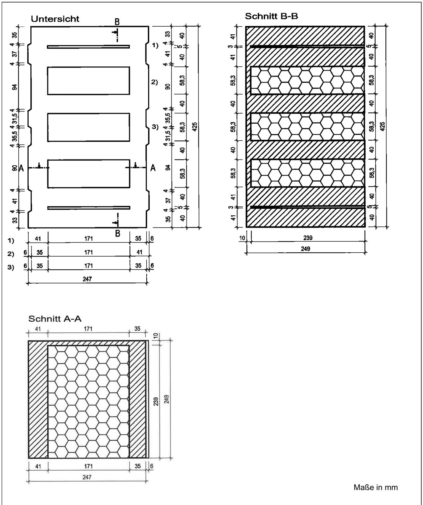
Mauerwerk aus KLB-SKD Steinen mit integrierter Wärmedämmung im Dünnbettverfahren
