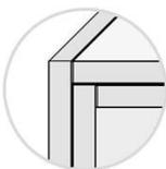
Bauart für feuerwiderstandsfähige Wand- und Deckenkonstruktion "System Knauf Cubo" für Flure als Begrenzung von Rettungswegen der Feuerwiderstandsklassen F30 bzw. F90 nach DIN 4102-2
