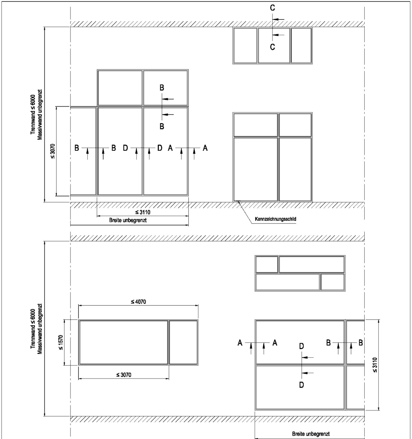
Maximale Kämpferlängen: Serie VF 3010 mm (horizontal / vertikal)
