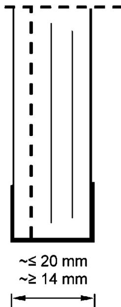
Brandschutz-Verbund-Sicherheitsglas bestehend aus Floatglasscheiben mit zwischen liegenden Funktionsschichten und PVB-Folie.
