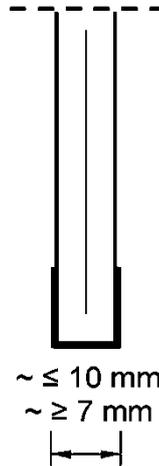
Brandschutz-Verbundglas bestehend aus Floatglasscheiben mit zwischen liegenden Funktionsschichten.
