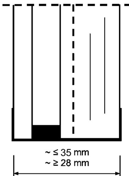
Brandschutzisolierverglasung bestehend aus Verbund-Sicherheitsglas aus Floatglasscheiben mit zwischen liegenden Funktionsschichten und PVB-Folie sowie vorgesetzter Außenscheibe.
