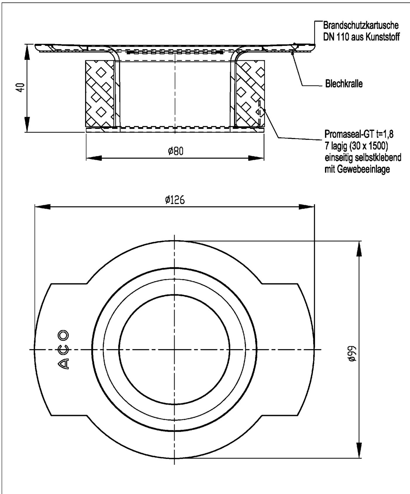
Zubehöerteile für feuerwiderstandsfähige Abschottung "System Bodenabläufe Easy Flow"
