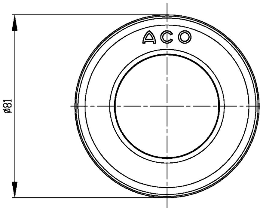
Zubehöerteile für feuerwiderstandsfähige Abschottung "System Bodenabläufe Easy Flow"
