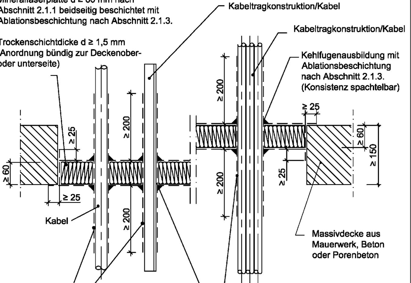
Beschichtung der Kabel und der Kabeltragekonstruktion mit Ablationsbeschichtung nach Abschnitt 2.1.3. Trockenschichtdicke  $d \geq 1,5$  mm
