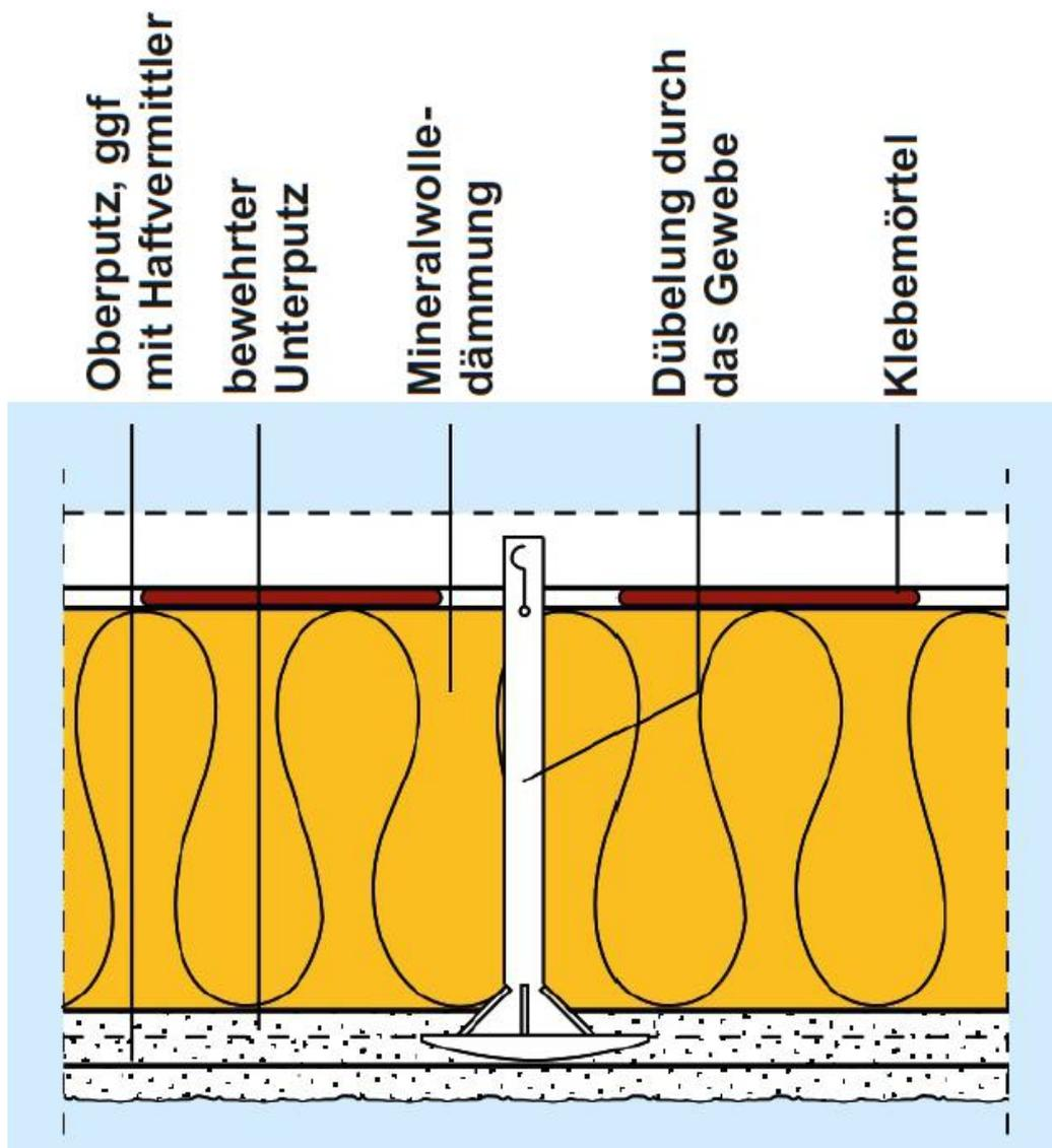
**Aufbau des WDVS "ROTHHERM EPS Wärmedämm-
