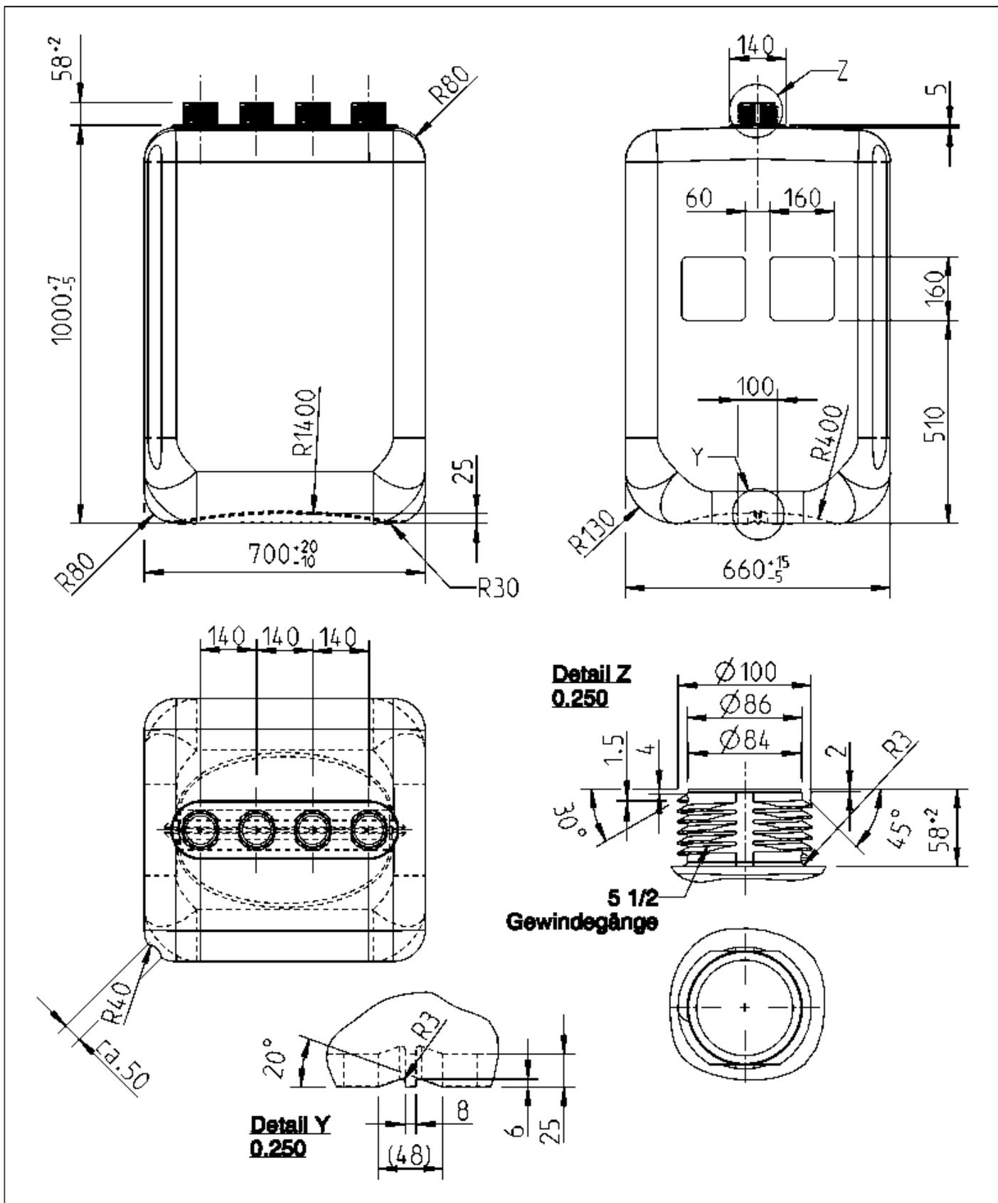
Blasgeformte Behälter aus Polyethylen (PE-HD)
