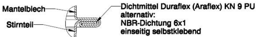
**Bördelnaht mit Dichtung**
